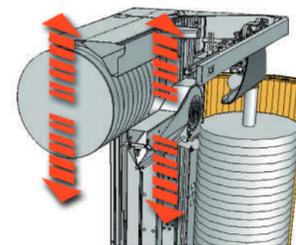
Gleichzeitige Bewegung der horizontalen Bürste und des oberen Trocknungsmessers beim Durchgangswechsel für höhere Produktivität.
